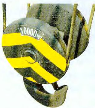
图 11 起重机械吊钩部位的黄黑相间标志
