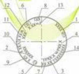
图 B-3 气瓶制造钢印的项目和排列 (溶解乙炔气瓶及焊接绝热气瓶等除外)
