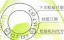
(b) 打在金属检验标志环的定期检验侧印标记
