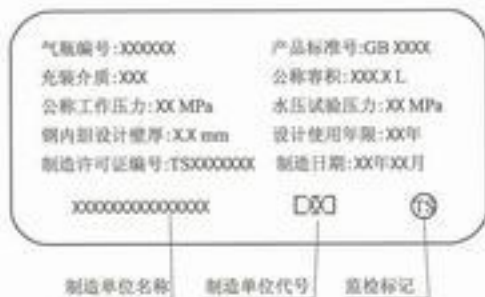
图 B-5 缠绕气瓶制造标签标记的项目和排列
