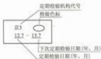
图 B-6 缠绕气瓶定期检验标签标记的项目和排列
