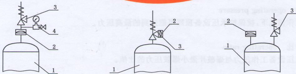
a) 爆破片串联在安全阀入口侧    b) 爆破片串联在安全阀出口侧    c) 爆破片与安全阀并联
