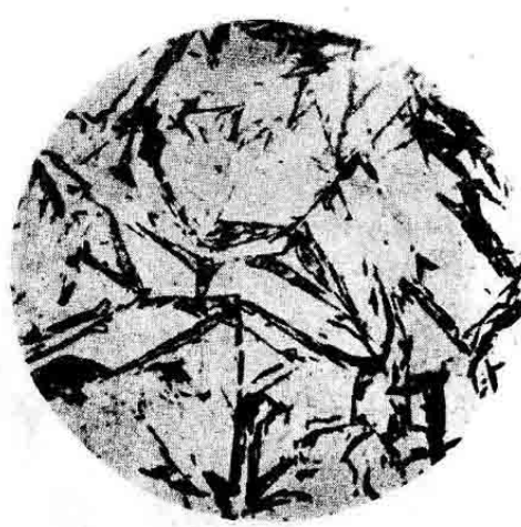
第8级 (粗针马氏体, 针的长度 >16\text{ mm}\sim 25\text{ mm} )
