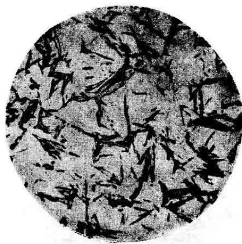
第7级 (粗针马氏体, 针的长度 12\text{ mm}\sim 16\text{ mm} )
