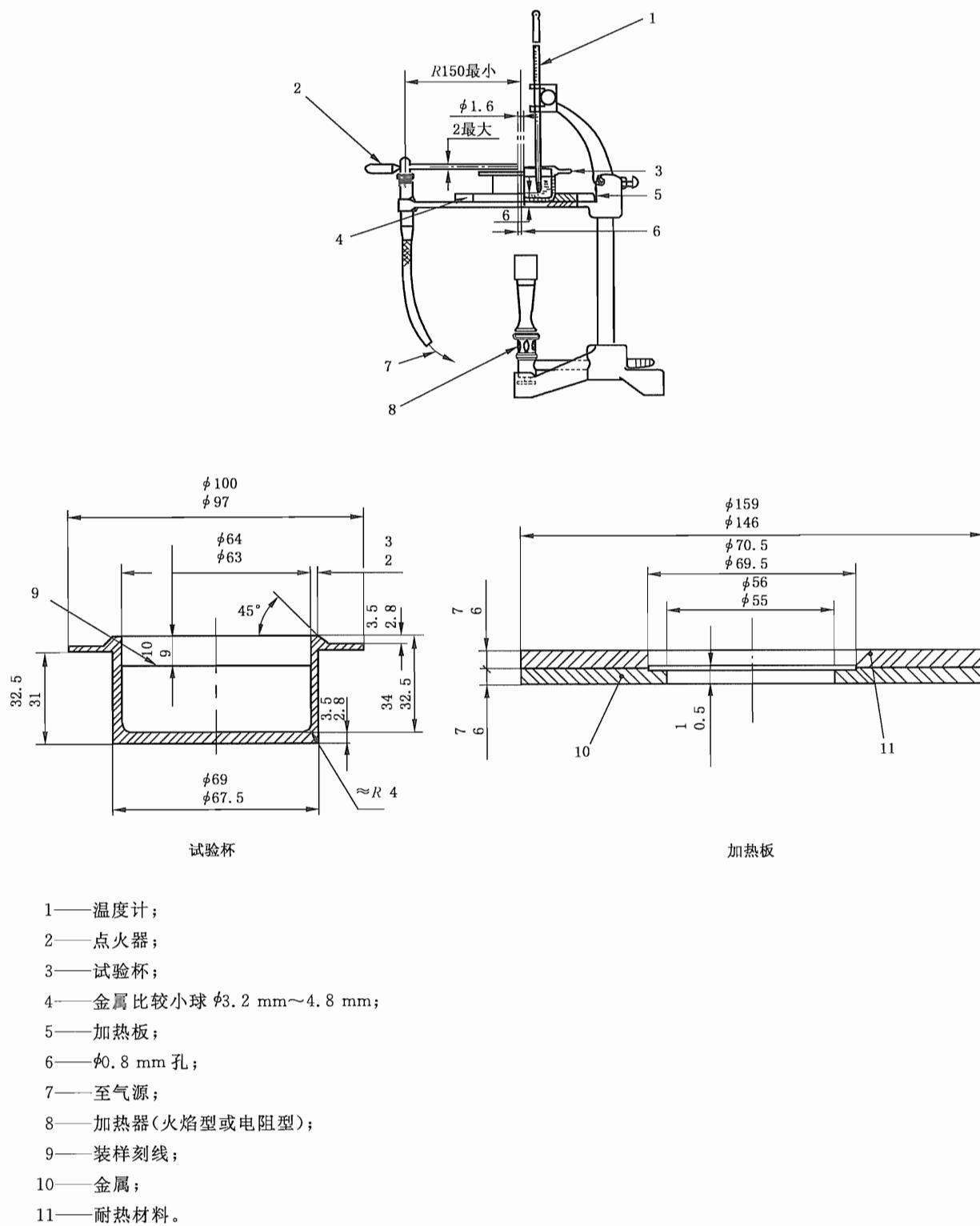
图 A.1 克利夫兰开口试验杯仪
