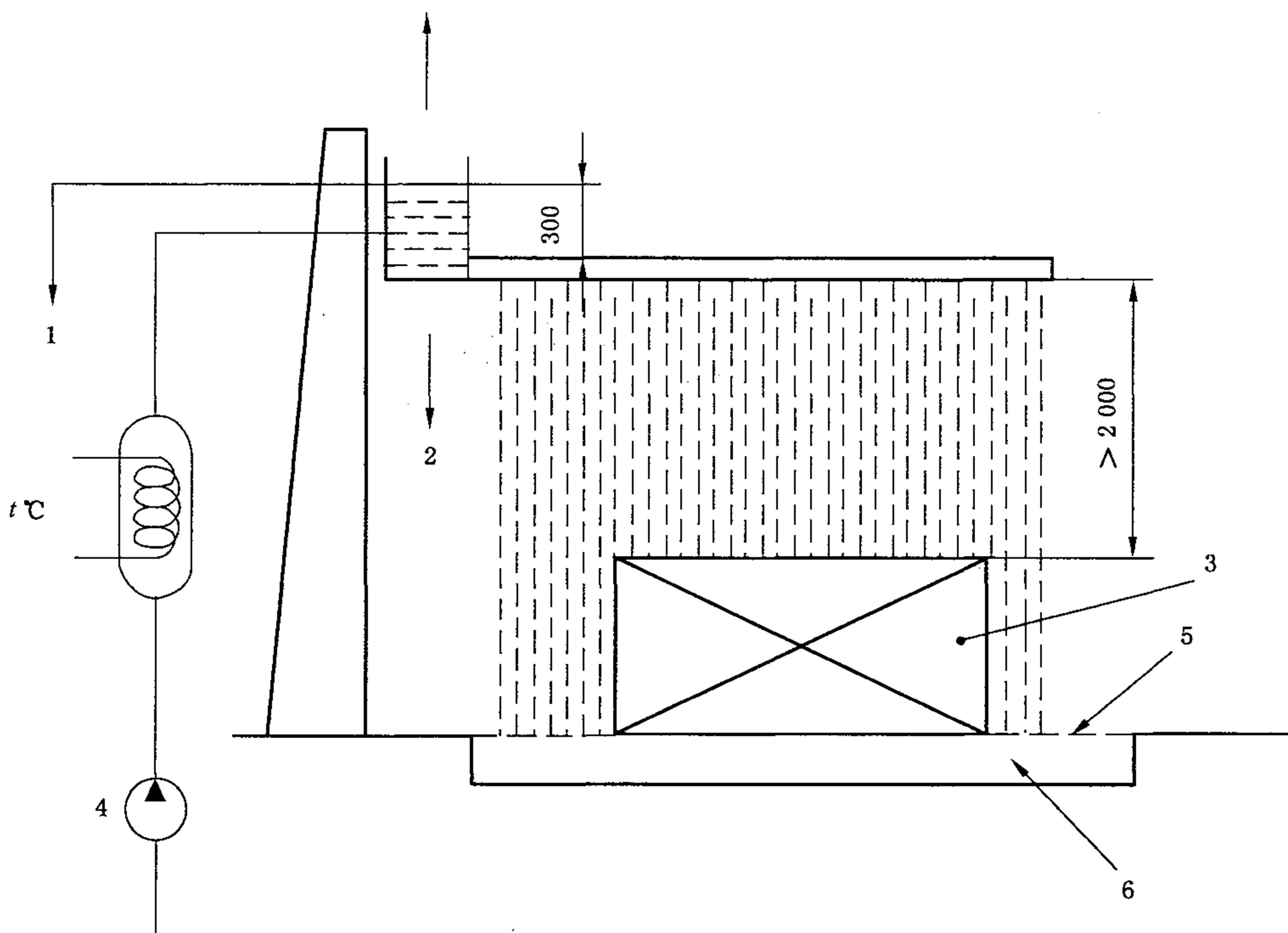
图1 喷淋试验装置示意图
