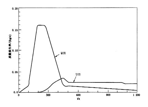
图 B.7 家具和导管的比较质量损失率(石膏灰泥板)
