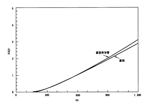
图 B.8 相对毒性因导管暴露而增强(混凝土墙)
