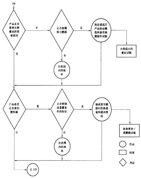
流程图 2B 火焰/火蔓延或/和放热
