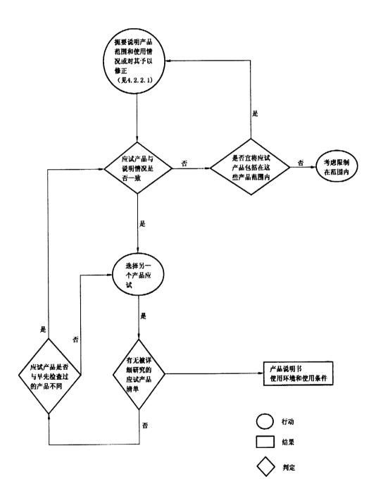
流程图 1 电工电子产品的范围和使用情况(见 4.2.2.1)
