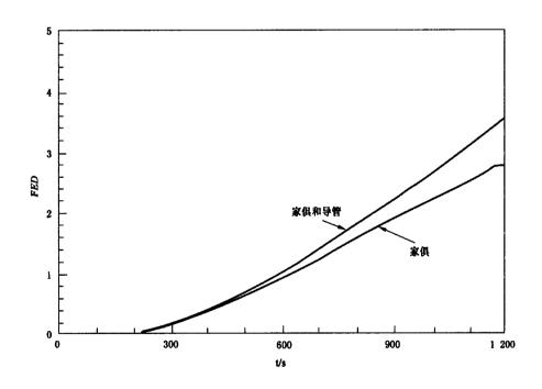
图 B. 9 相对毒性因导管暴露而增强(石膏灰泥板)
