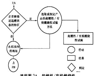
流程图 2A 起燃性/有焰燃烧性
