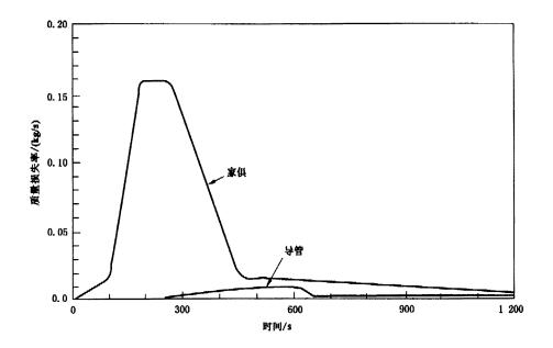
图 B.6 家具和导管的比较质量损失率(混凝土墙)
