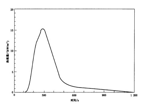
图 B.5 在离导管 2 m 处测得的热通量(石膏灰泥板)
