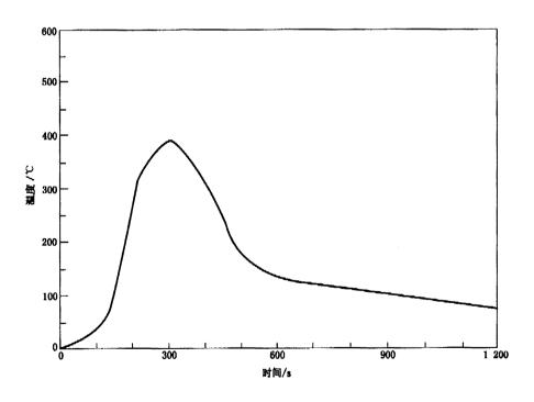
图 B.3 走廊上层的温度(石膏灰泥板)
