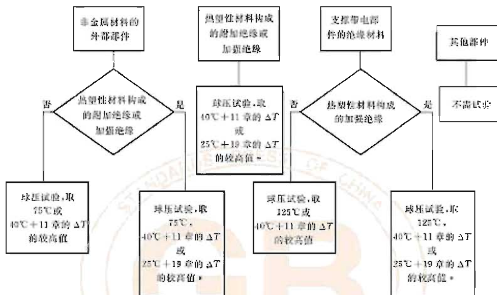
图 O.1 耐热试验
