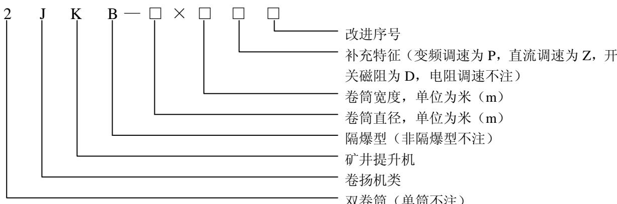
示例 1：卷筒直径为 3m、宽度为 2.2 m，采用非隔爆型电阻调速的单卷筒简单绳缠绕式矿井提升机的产品型号为：JK-3×2.2；
