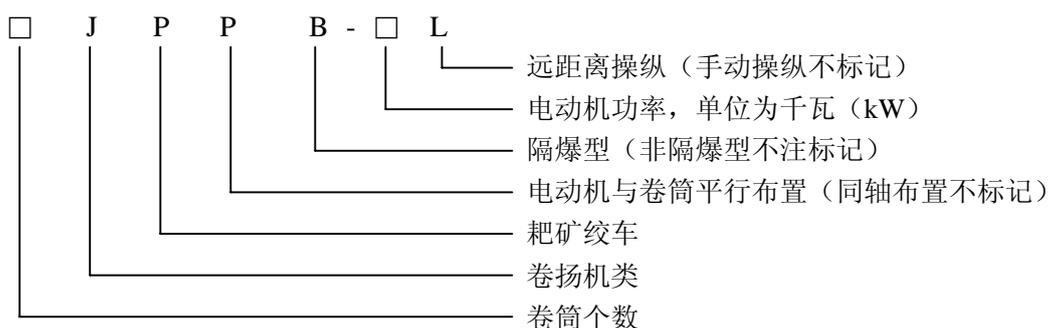
示例 1: 2JPPB-15 表示电动机功率为 15kW, 手动操纵的隔爆型双卷筒, 电动机与卷筒平行布置的耙矿绞车;
