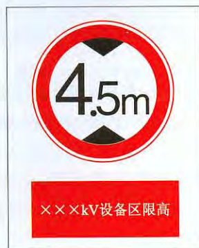
图5 变电站通道限制高度禁止标志牌示例
