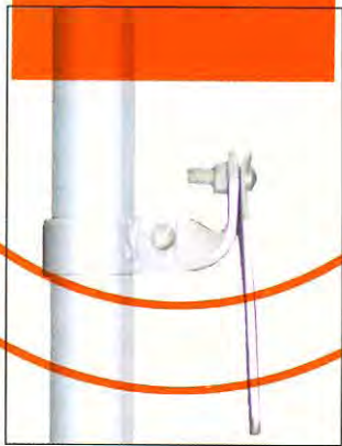
图 10 阀门标志牌固定方式示例
