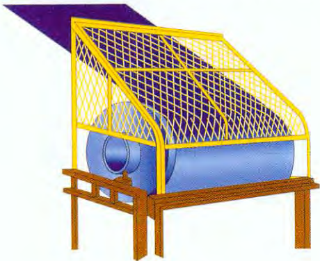
图 A. 65 输煤皮带防护遮栏制作标准
