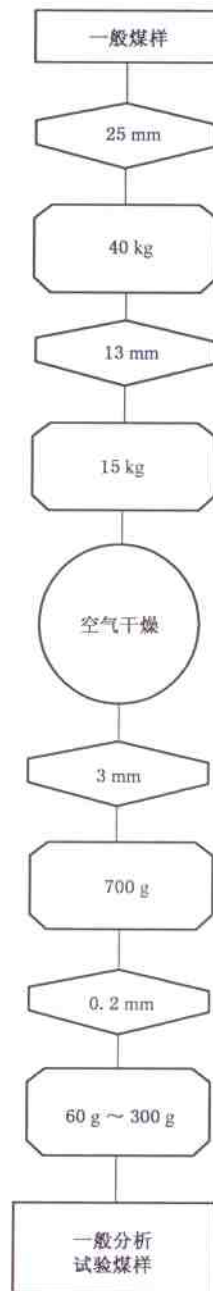
图 10 一般分析试验煤样制备程序示例
