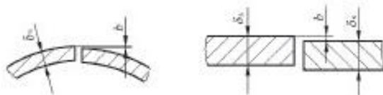
图 2 对接焊接接头对口错边量 b
