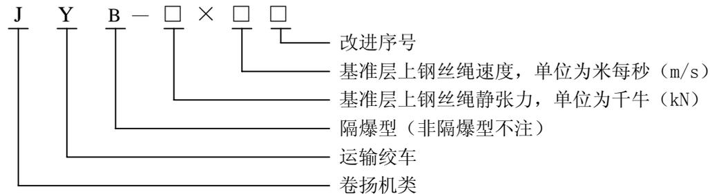
示例 1：基准层上钢丝绳静张力为 40kN，基准层上钢丝绳速度为 1.25m/s 的隔爆型运输绞车：JYB-40×1.25；
