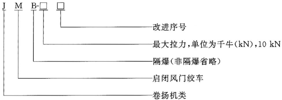
示例 1:钢丝绳最大拉力为 20 kN 的非隔爆型启闭风门绞车:JM-2;
