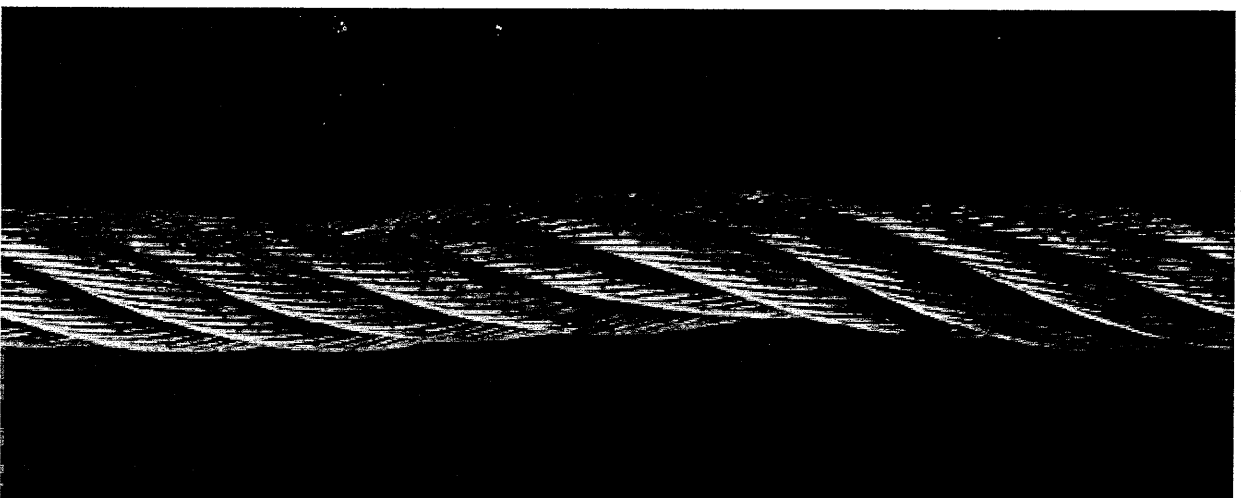
图 B.3 钢丝绳直径局部减小(绳股凹陷)
