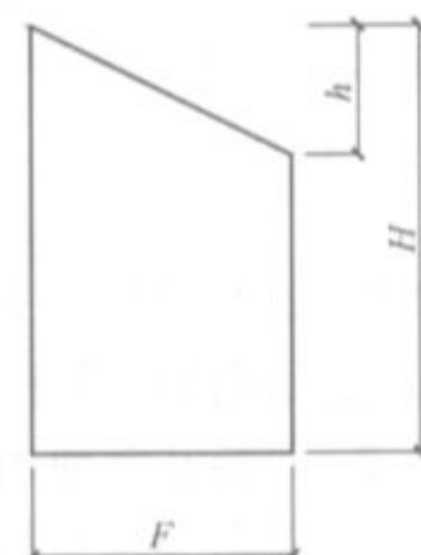
图 4.1.1 混凝土侧压力计算分布图形
