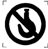
图 6 不允许使用吊钩工况的符号
